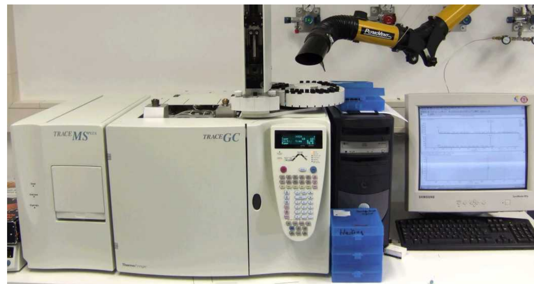
GC-MS : Thermo Trace MS Trennsäule: HP-5MS (30 m x 0,25 mm x 0,25 µm)
