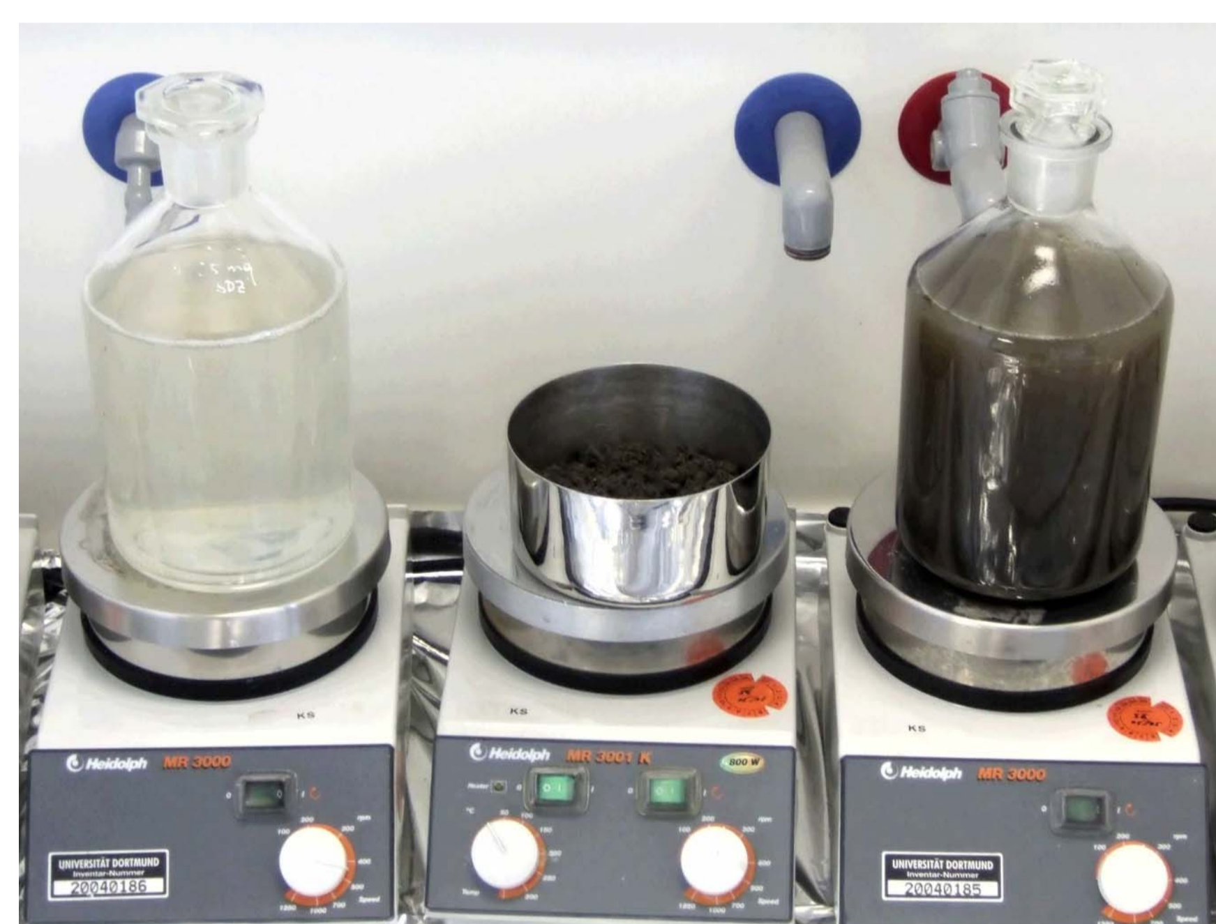
Behandeltes Abwasser Rohabwasser Klärschlamm (getrocknet)
